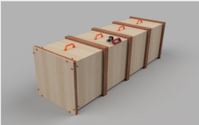
Peč za termično obdelavo laminatov (arhiv FS)
